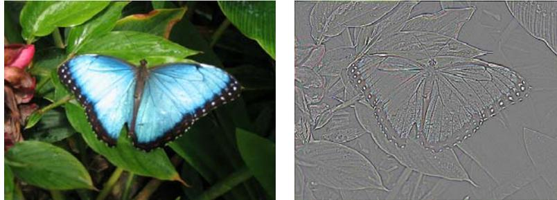
Gambar 10. Hasil operasi *edge detection filter* (a) Citra asli; (b) Citra yang telah dilakukan *edge detection*
